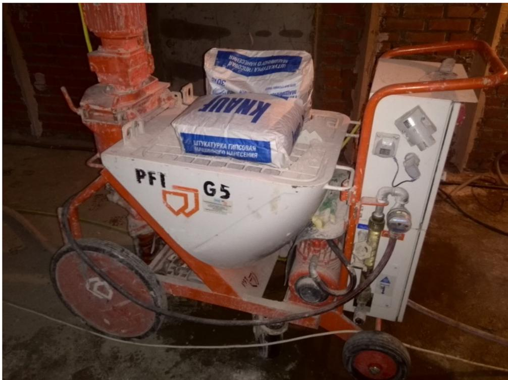
*Рис. 3 Подключение штукатурной машины*
