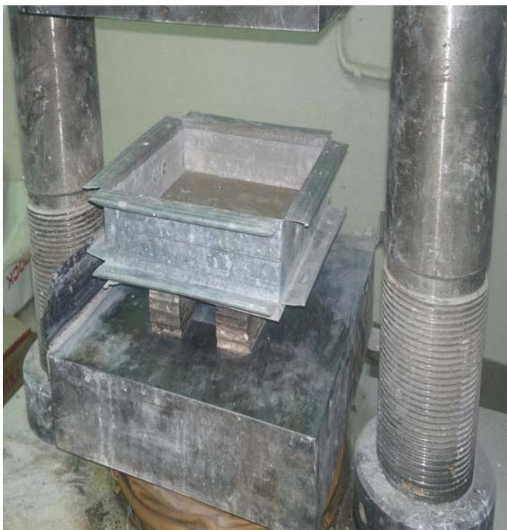
Рис. 1 Внешний вид устройства, для формования образцов ГВЛ
