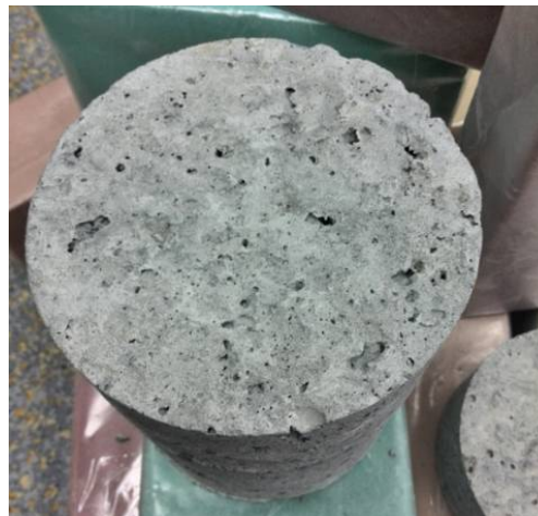
Рис. 1. – Воздушные пустоты на границе монолитной и сборной части керна
