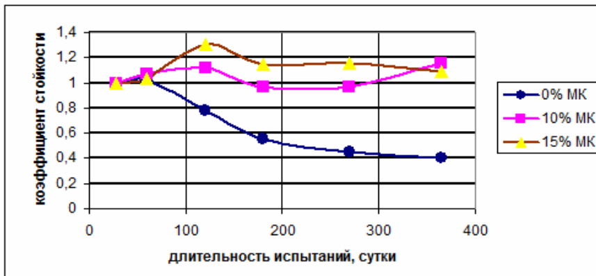
Рис. 2 - Результаты испытания сульфатостойкости цемента с 4% C_3A и различным содержанием микрокремнезёма.
